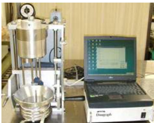
写真2. ドウグラフ(左がピンミキサー部)
