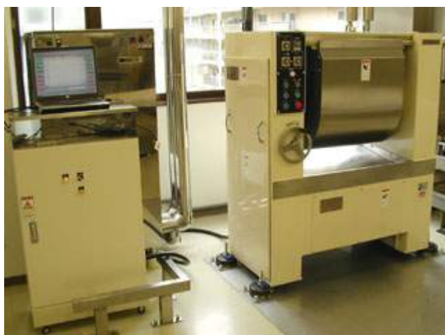
写真12. 横型ミキサー(左:デベロップモニター)
