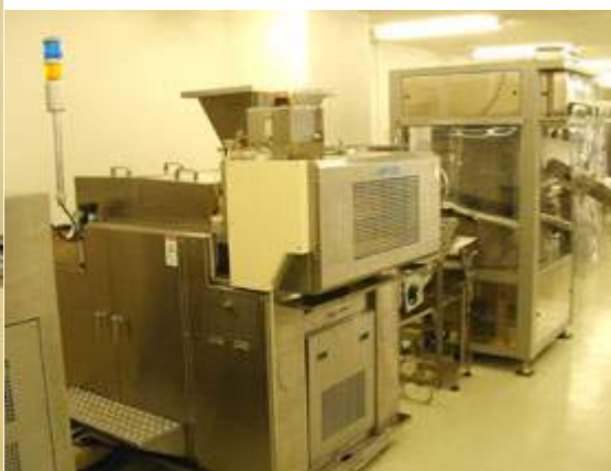
写真15. 油圧ピストン型ディバイダー・ラウンダー
